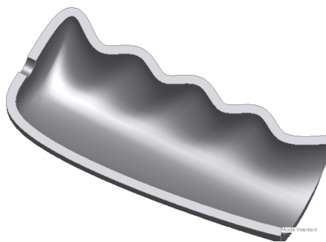
Figure 13 : Surface composée épaissie afin de générer du solide.
